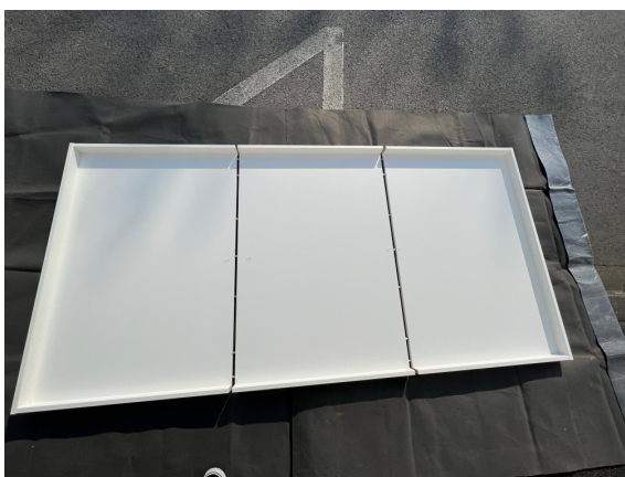
Oberseite mit geöffneten Exzenterbeschlägen (Schnittlinien deutlich erkennbar)
