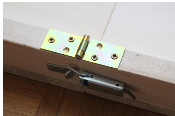
Klappscharnier auf und Schnellspanner außen an der Bande (Schnittlinie rechts)
